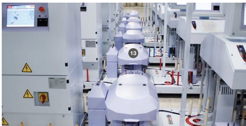
13 Combinación con la máquina bobinadora: Zinser 351 con CoWeMat 395 V Página 19
